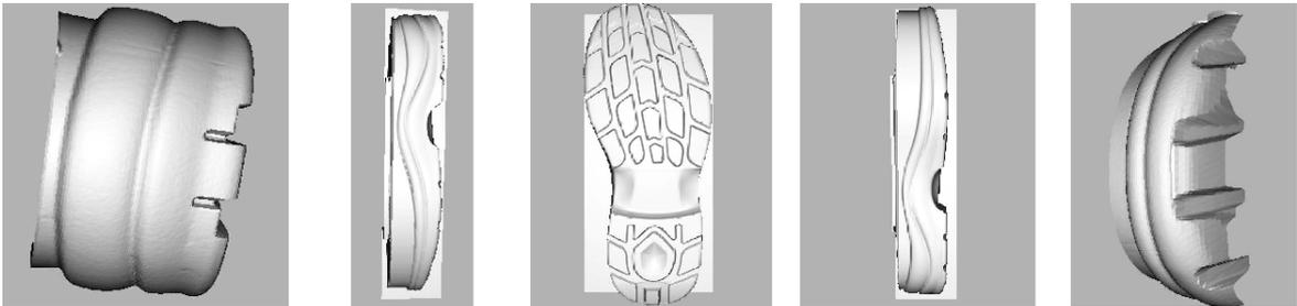
La fase 2 non è necessaria perché le matrici di rotazione per la registrazione sono fornite dai sensori utilizzati in fase di scansione.
